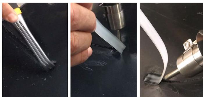
Hot Air consente di effettuare saldature sulla plastica grazie ad un getto di aria calda che fonde insieme le plastiche da saldare. Pratica e maneggevole è dotata di regolatore di flusso e di display per il controllo della temperatura.
