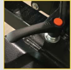
G108A40 Bloccaggio albero Shaft position lock
