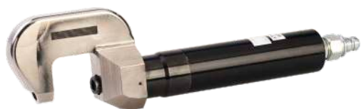
◀ Trancia 10 Ton idraulica per il taglio della lamiera. Utilizzabile per la foratura con punzoni da 0,6 mm e da 0,8 mm. Questo accessorio è necessario per la foratura della nuova lamiera in alluminio e per la calibratura dei fori esistenti delle lamiere in alluminio e in acciaio. Foratura della lamiera in acciaio al boron fino a 3 mm.
