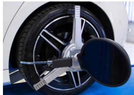
I target con obiettivo 3D installati sulle griffe sono estremamente leggeri, esenti da manutenzione e senza componenti elettronici. Rilevano in pochi secondi tutti gli angoli del veicolo senza interventi da parte dell'operatore.
